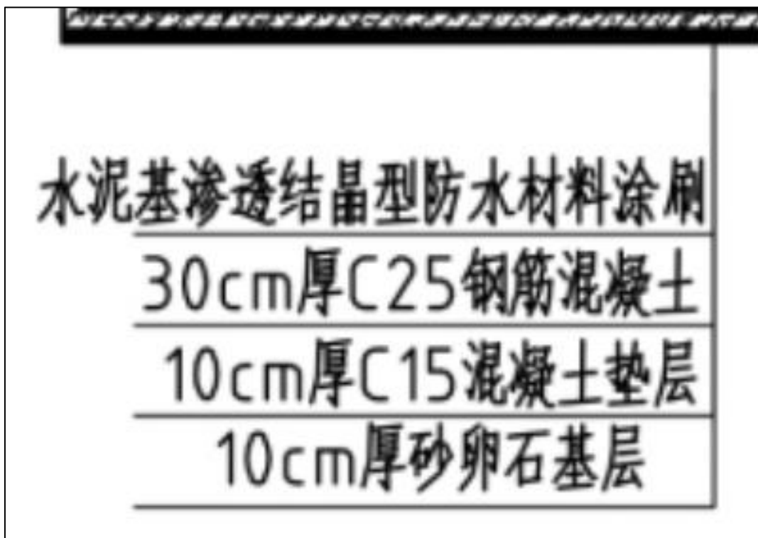
图 8.2.3-1 重点防渗区地面防渗结构示意图
